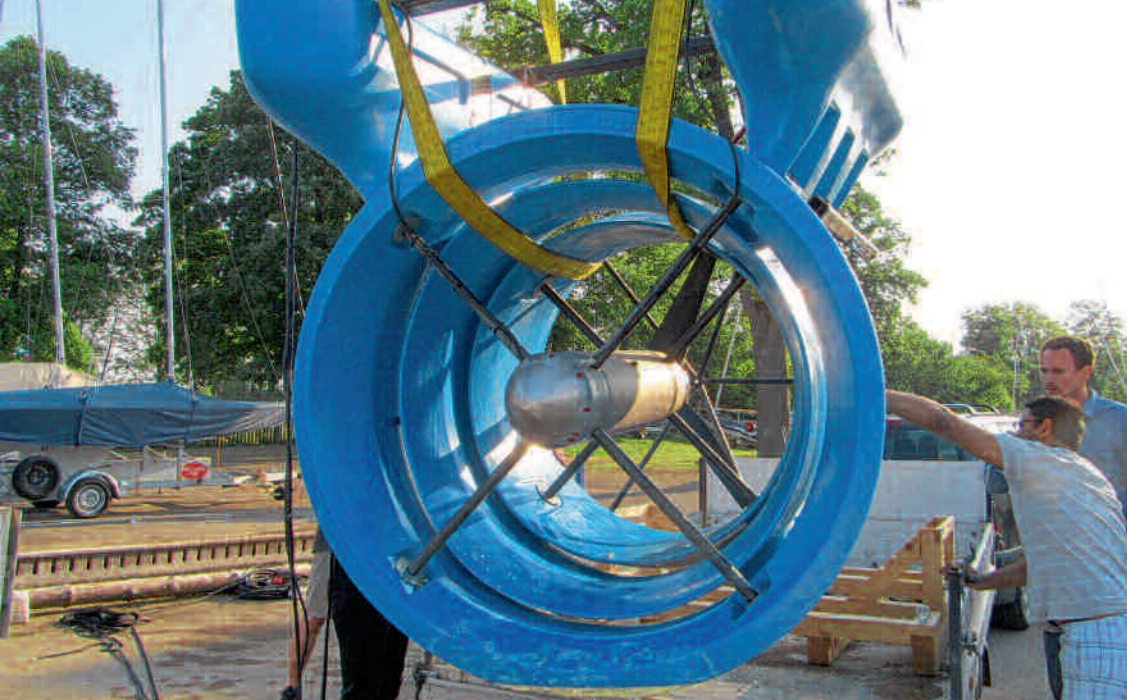
Die Flussturbine soll künftig auch im Rhein Strom erzeugen, dabei für Fische aber keine Gefahr sein.
